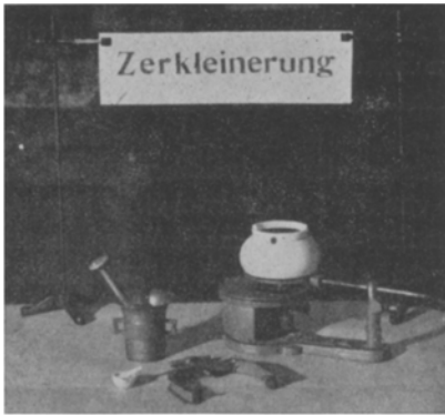
Abb. 6. Durchschnittsproben durch Zerkleinerung; Mörser, Reibschale und Bloch-Rosetti-Mühle.
