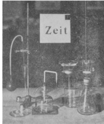
Abb. 5. Zeitgewinn durch Mikrofiltration, links Mikrofiltrierpipette und Filterglocke, rechts bekannte Makrofiltrationsgeräte.
